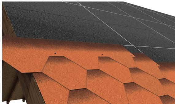
Гонт крепится четырьмя кровельными гвоздями на расстоянии 2 см от верхнего края канавок при уклоне кровли до 45° (рис. 9а). При уклоне более 45° каждый гонт крепится шестью гвоздями (рис. 9б).
